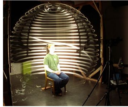
Urządzenie Light Stage - wykonanie serii zdjęć z oświetleniem z różnych kierunków.
